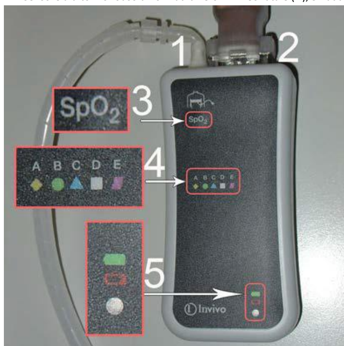
Fig.: Unità PPU wireless. 1: connettore del sensore respiratorio, 2: connettore dell'unità PPU (Peripheral Pulse Unit), 3: testo che indica il tipo di dispositivo: SpO 2 (in caso di PPU) o VCG, 4: indicatore della rete corrente, 5: Indicatore di stato della batteria
